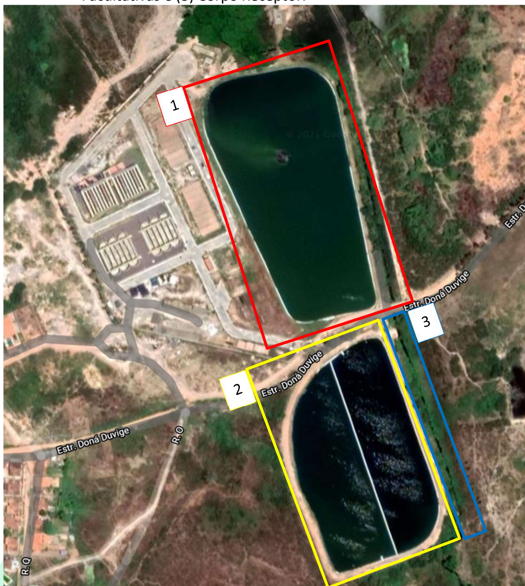
Imagem 1: Visão aérea da ETE Lagarto, (1) Lagoa Anaeróbia, (2) Lagoas Facultativas e (3) Corpo Receptor.
