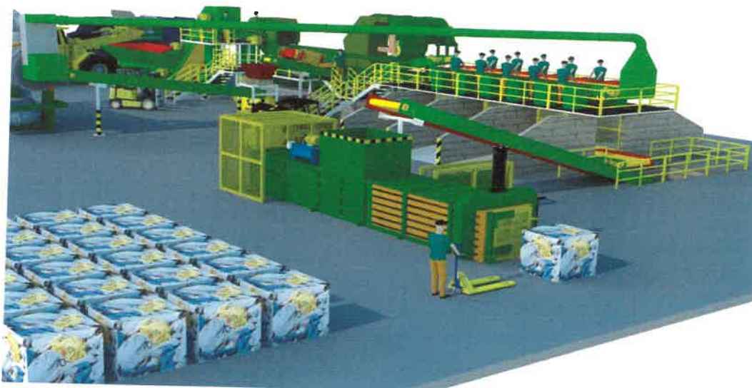
Figura 9 - Imagem detalhada do sistema de prensagem de recicláveis.
