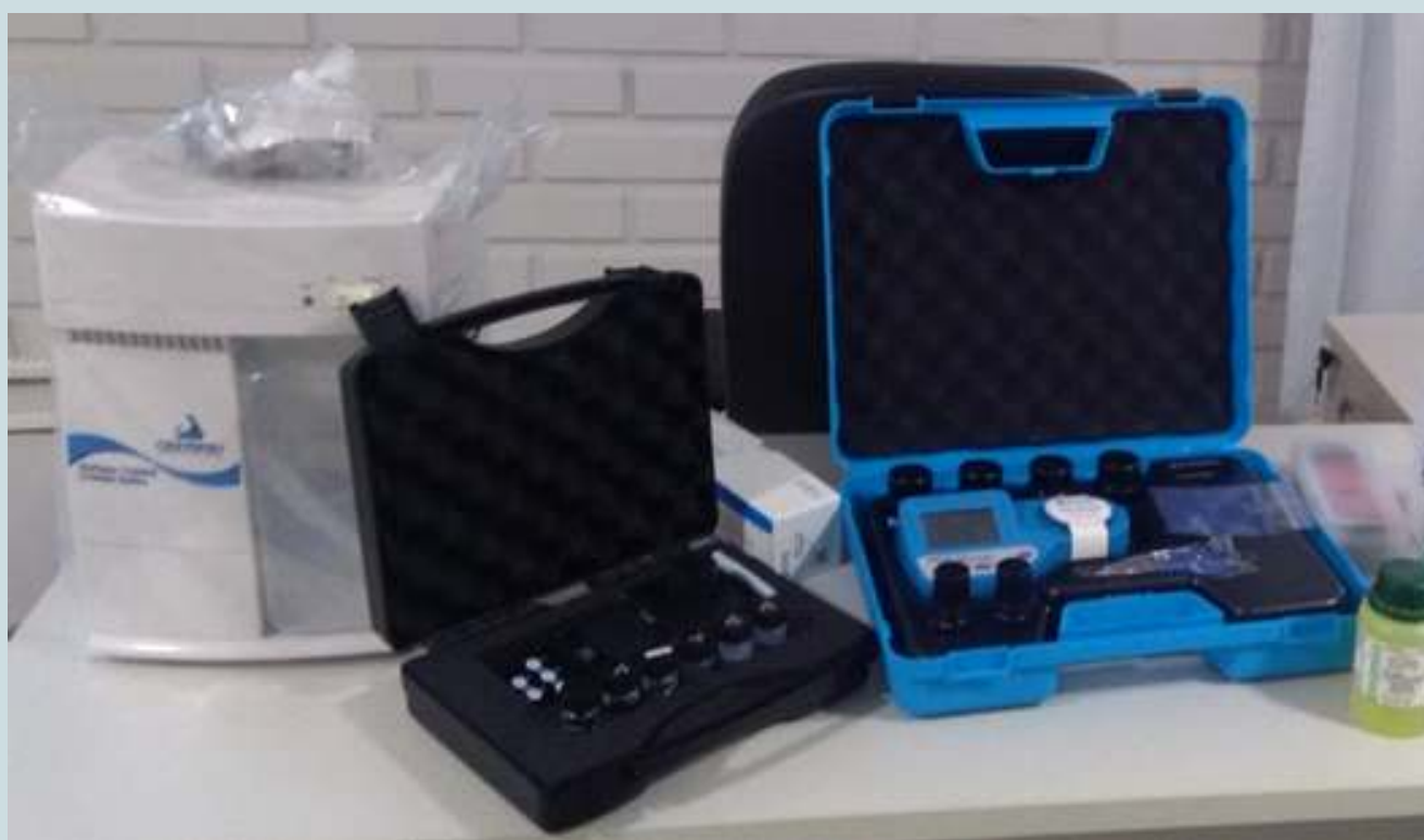
Figura 23: Equipamentos utilizados para análise da qualidade da água: destilador, turbidímetro, fotômetro e Phmetro.
