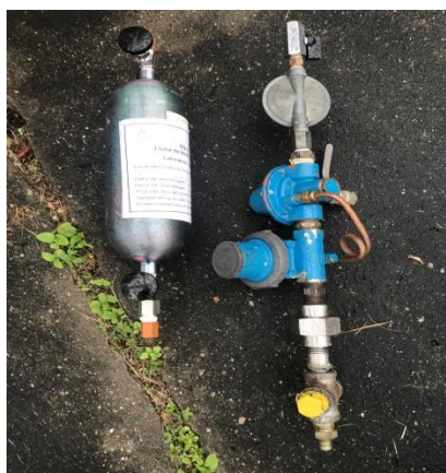
Figura 1: Cilindro de coleta e equipamento usado para a coleta
